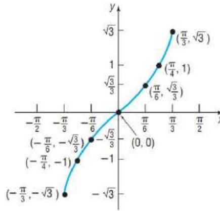
Para completar un período de la gráfica, podemos investigar el comportamiento de la función cuando  $x$  se acerca a  $-\frac{\pi}{2}$  y  $\frac{\pi}{2}$ . La función tangente no está definida para esos valores. Para determinar el comportamiento usamos la identidad  $\text{tg } x = \frac{\text{sen } x}{\text{cos } x}$ .
